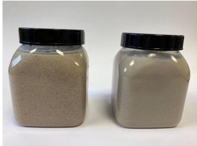
Abb. 9: Links: Sorelbeton ohne Anhydritmehl; rechts: mit Anhydritmehl
