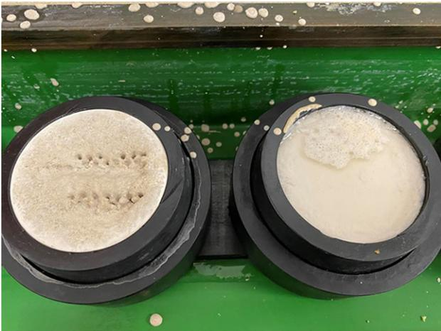
Abb. 8: Links: Sorelbeton mit Anhydritmehl (8%); rechts: ohne Anhydritmehl
