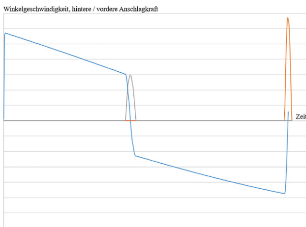
Abb. 13: Auswertung der vorderen Prallschwinge – Winkelgeschwindigkeit (blau), hintere Anschlagkraft (1. Peak, grau), vordere Anschlagkraft (2. Peak, orange)
