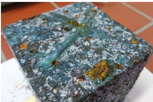
Abb. 6: Bild eines Betonprüfkörpers aus Reststoffen. Die Ausblühungen an den Prüfkörperoberflächen weisen auf chemische Reaktionen während des Aushärtevorganges hin
