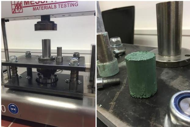
Abb. 7: Links: Die verwendete Pressvorrichtung zur Prüfkörperherstellung am Lehrstuhl für Aufbereitung und Veredlung; Rechts: Ein Beispiel eines frisch hergestellten Prüfkörpers
