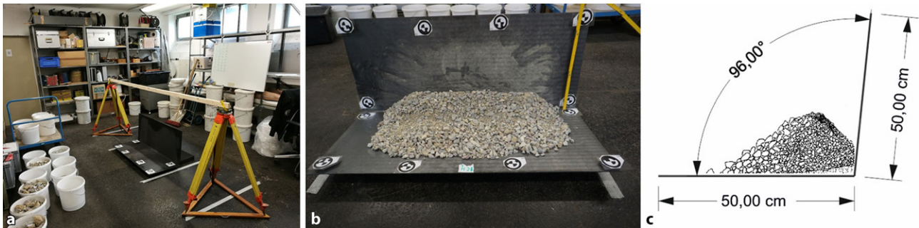
Abb. 3: Modellversuchsaufbau. a zeigt die gesamte Anordnung im Überblick. b zeigt exemplarisch eine Versuchskörnung und c können die Abmessungen des Systems entnommen werden
