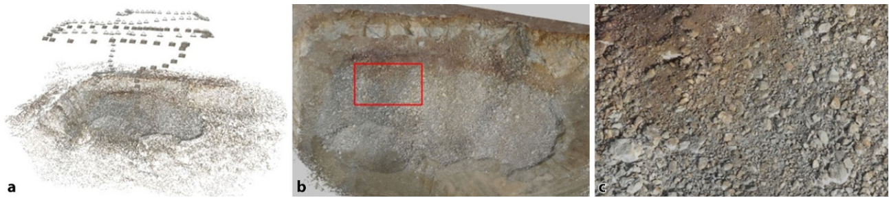
Abb. 1: 3D Rekonstruktionsergebnis. a Das Structure-from-Motion (SfM) Ergebnis enthält eine dünne Punktwolke und die Kamerapositionen. b Nach dem Multi-View Stereo Schritt wird die Punktwolke wesentlich dichter und besteht aus Millionen von Punkten. Das rote Viereck markiert den Ausschnitt (c)
