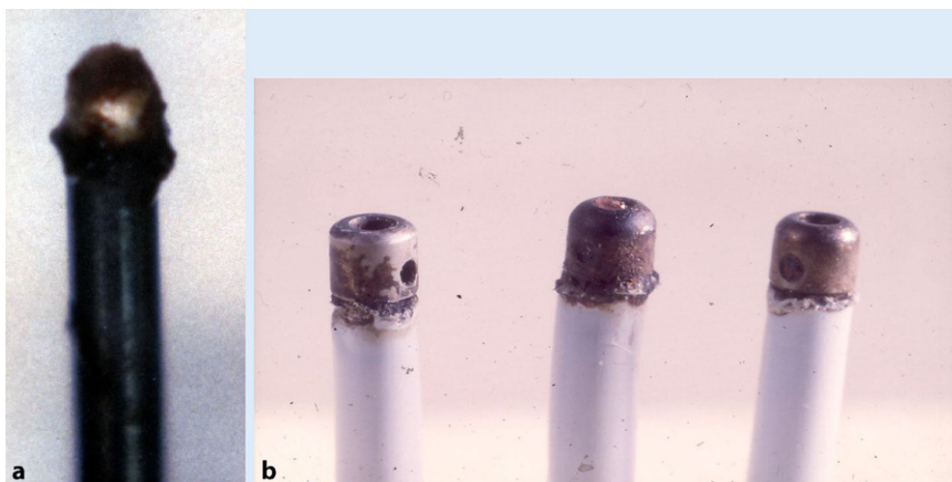
Abb. 2 ▲ Elektroden nach Diathermie-Ablation. Man erkennt Karbonisation (a) und Isolationsdefekte (b) an der Elektrodenspitze aufgrund der hohen Stromdichte und Hitzeentwicklung
