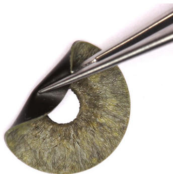
Abb. 2 ▲ Individuell angefertigte künstliche Iris aus Silikon. Durchmesser von 12,8 mm (trepazierbar), definierte Pupillenweite von 3,35 mm, die Materialstärke nimmt vom Pupillarrand zur Peripherie hin ab. Die Vorderfläche wird nach fotografischer Vorlage des gesunden Partnerauges individuell modelliert, die Rückfläche bildet eine glatte, schwarze und lichtundurchlässige Silikonschicht
