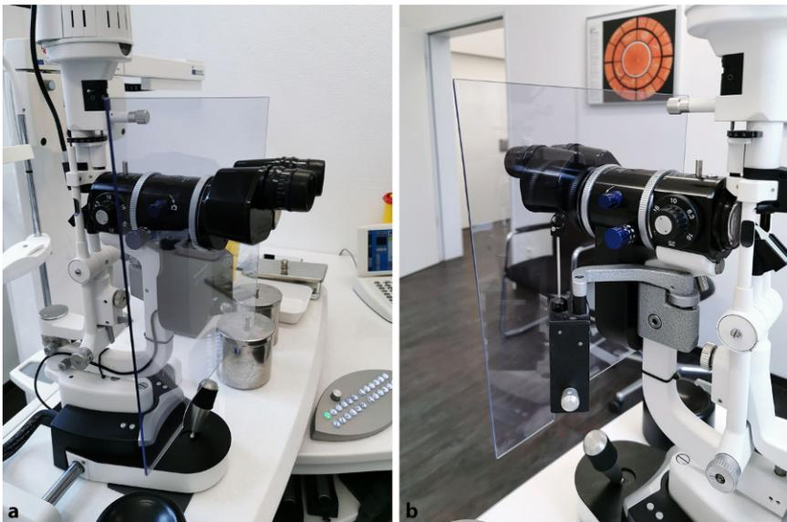
**Abb. 3** ▲ a, b Ansicht der Spaltlampe nach Montage des Schutzschildes
