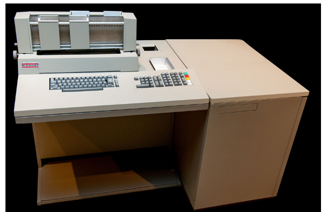
Abb. 2 Nixdorf-Magnetkontencomputer mit Lochkartenleser 820/35, 1970. Die 820-Systeme mit ihren verschiedenen Peripheriegeräten waren echte Arbeitsplatzcomputer, die Rechenkapazitäten am Arbeitsplatz des Sachbearbeiters zur Verfügung stellten. Der Drucker mit Kontenblatteinzug und Endlosformular ermöglichte Fakturieren und Buchen in einem Arbeitsgang. Mit Magnetkernen als externen Datenspeichern wurden die Ausgangsdaten automatisch und fehlerfrei vom Kontenblatt in den Computer eingelesen. Der Rechner ist ausgestellt im Heinz Nixdorf MuseumsForum, Paderborn. (Inv.-Nr.: E-1994-1645. Foto: Sergej Magel, Heinz Nixdorf MuseumsForum)
