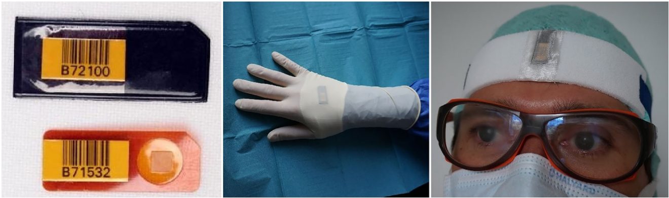
Abb. 2 ▲ Thermolumineszenz-Chipstrate-Dosimeter (TLCD) an Handrücken und Stirn des Operateurs
