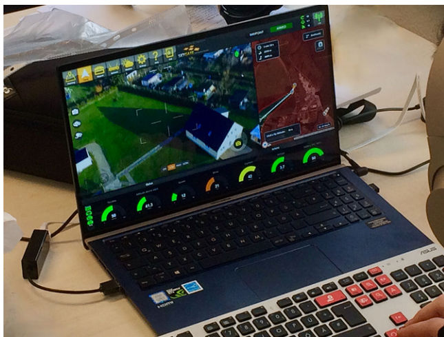
Abb. 2 ◀ Anwenderfreundliches Steuerungssystem: nach Erreichen der Zielkoordinaten im autonomem Anflug erfolgt die Auswahl des Landeplatzes per Mausklick. Das entsprechende Video der Landung, gefilmt aus der Bodenperspektive, finden sie im Zusatzmaterial online: Video 3 (s. Box am Anfang des Artikels)
