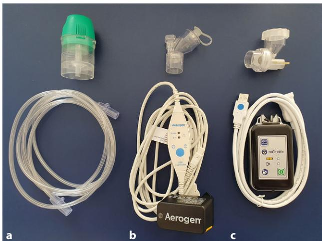
**Abb. 2** ◀ Vernebler. Die 3 getesteten Vernebler: a ein Jet-Vernebler (Cirrus 2; Fa. Intersurgical), b Mesh-Vernebler (Aerogen Solo mit USB-Controller; Fa. Aerogen Limited) und c Mesh-Vernebler (M-Neb mobile; Fa. NEBU-TEC International med. Produkte Eike Kern GmbH)
