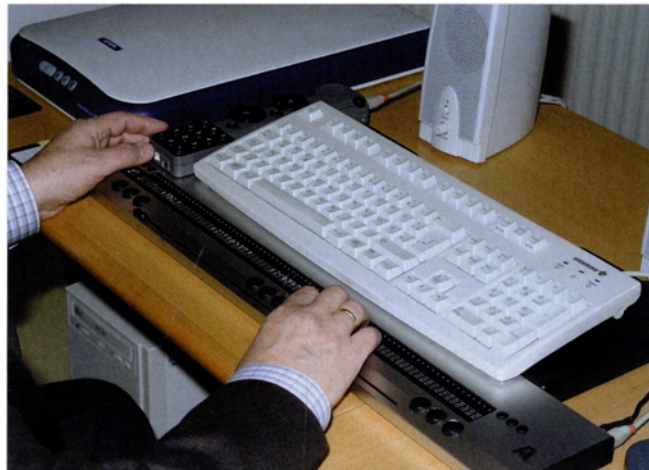
Mit Hilfe der Braille-Zeile können Blinde den Monitortext Zeile für Zeile lesen
