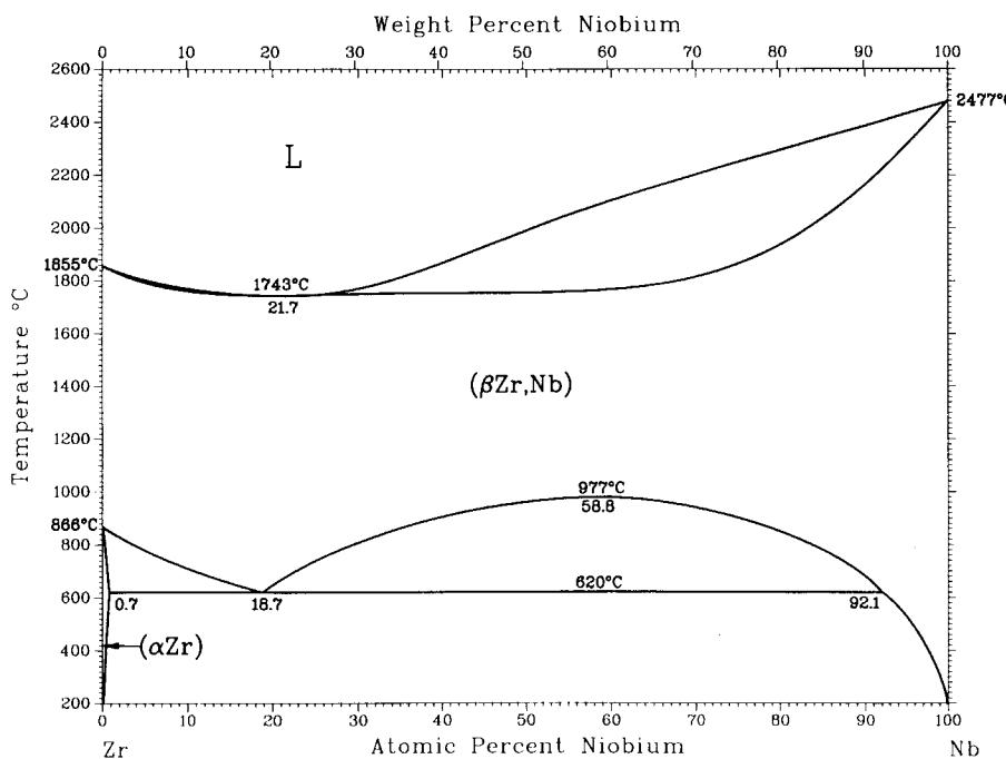
**Fig. 1** Zr-Nb phase diagram.
