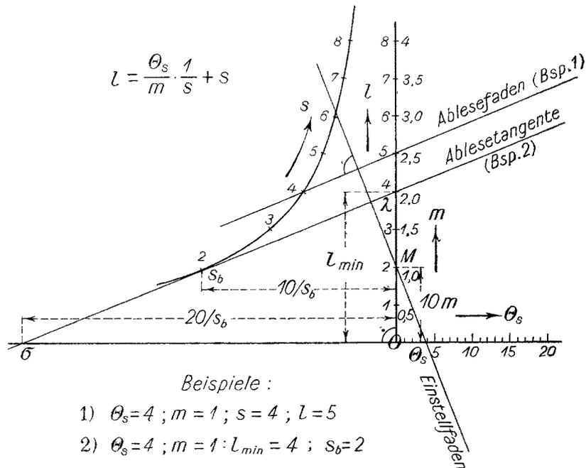
verschieben, bis der Ablesefaden durch den ebenfalls gegebenen  $s$ -Wert auf der Lösenden Kurve hindurchgeht. Er schneidet dann auf der 2-Leiter das gesuchte 2 ab. (s. Beispiel 1 in Abb. 2).
