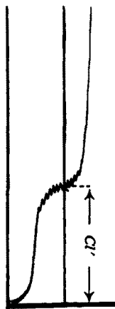
Fig. 1. Polarogramm mit Cl - -Stufe. Ansatz Serum 0,05 ccm, H 2 SO 4 n/10 ad 5,00 ccm, Empfindlichkeit: 1: 50, Temperatur 25° C. Die Stufe kann durch Vergrößerung der Empfindlichkeit der Apparatur beliebig groß geschrieben werden.
