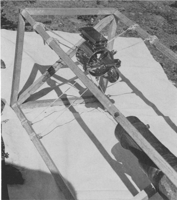
Abb. 2: Hinterteil des Netzeinsatzes zum „Hai“ mit kleinem Durchstrommesser TSK
