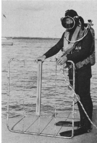
Abb. 4: Schwimmtaucher mit Probequadrat zur Vegetationsaufnahme. Am Quadrat ist ein 0,75 m langer Kapillartiefenmesser befestigt. Am unteren Rand der Vollgesichtsmaske befindet sich ein Mikrofon, dessen Kabel über den Kopfhörer zur Sicherheitsleine führt
