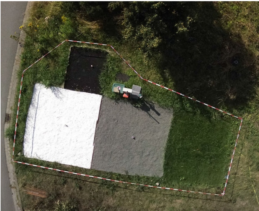
Abb. 3.10 Testflächen mit unterschiedlicher Oberflächenbedeckung auf dem UFZ-Gelände. Foto: M. Kreck
