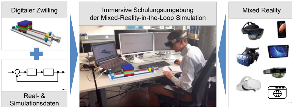
Abb. 18.11 Anbindung von Simulationstools an die VAL DTaaSP zur Mixed-Reality-in-the-Loop Simulation
