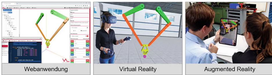
Abb. 18.10 Endgeräteunabhängige Visualisierung der Roboter-Kinematik im webbasierten Autorentool der VAL DTaaSP sowie über die Schnittstellenanwendung VAL HoloDesk auf verschiedenen MR-Endgeräten (VR und AR)
