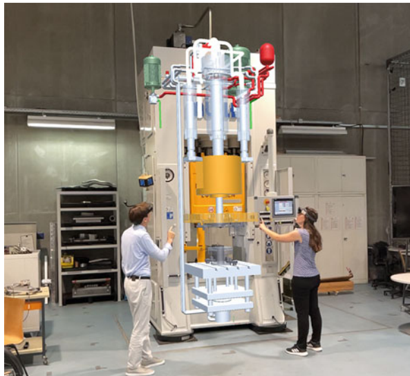
Abb. 18.12 Erweiterung einer realen Hydraulikpresse um die Visualisierung der Schaltprozesse der Ventile sowie der Druckzustände in den Hydraulik-Schläuchen mittels Augmented Reality
