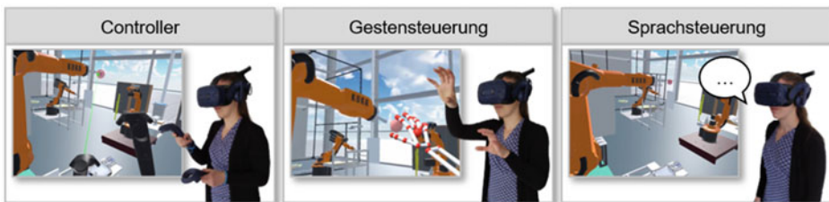
Abb. 16.18 Controller, Gesten- und Sprachsteuerungen zur Interaktion mit einem Digitalen Zwilling
