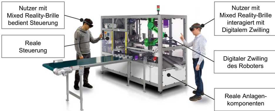
Abb. 16.2 Konzept der Mixed-Reality-in-the-Loop Simulation am Beispiel einer Sondermaschine
