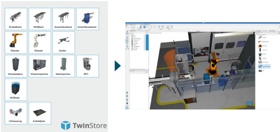
Abb. 11.6 Projektierung der virtuellen Anlage aus TwinStore Packages
