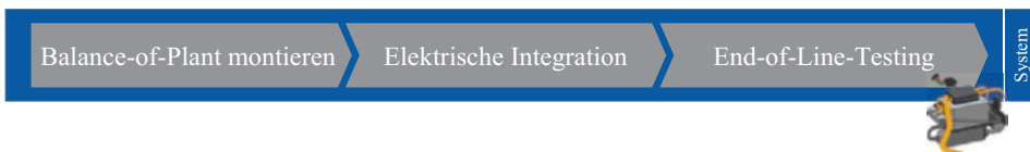
Abb. 16.4 Prozessablauf der System-Montage der Balance-of-Plant
