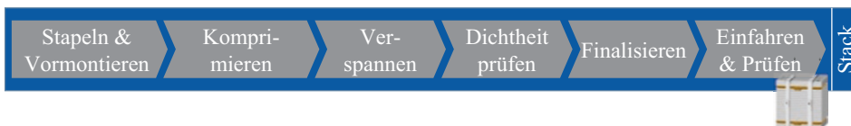
Abb. 16.3 Fertigungsprozess eines Brennstoffzellen-Stacks
