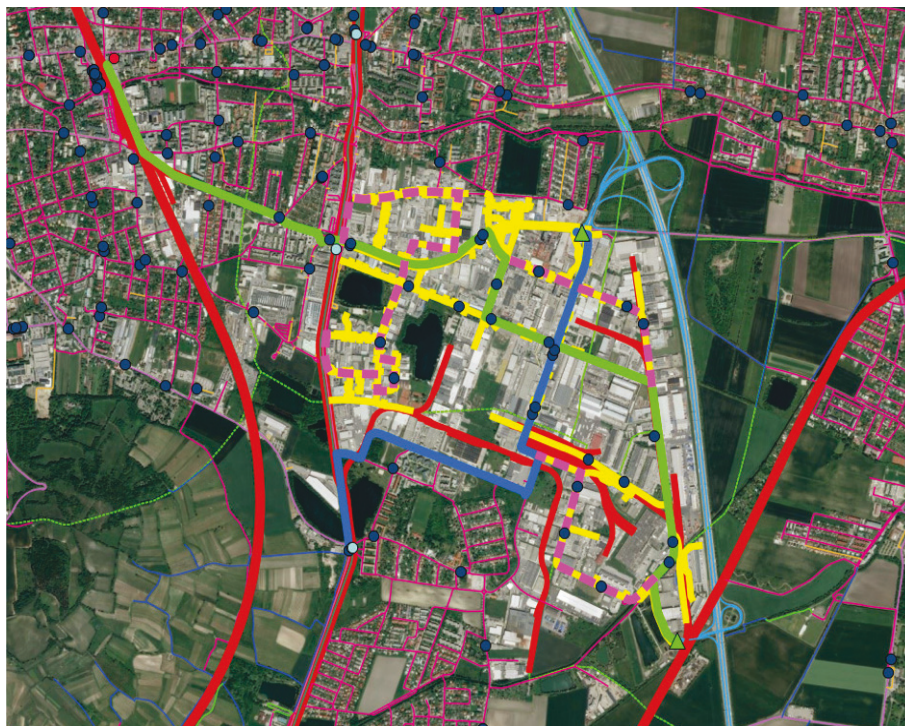
Erweiterung durch Expresslinien (grün und blau) zwischen den Anschlussstellen in der Transformationsstufe 2
