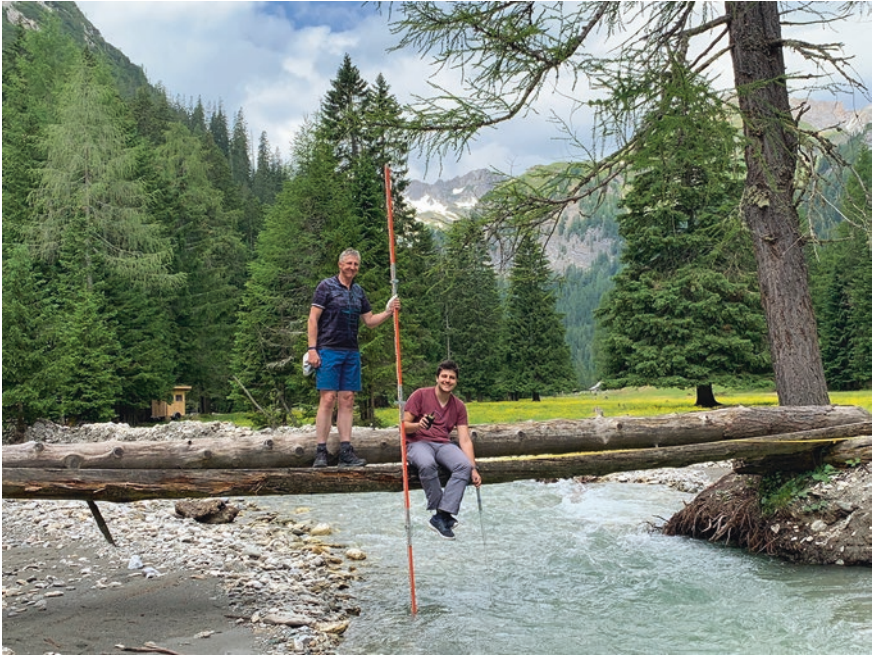
Abb. 5.1 Messung der Strömungsgeschwindigkeit mit einem Messflügel (Foto: Angela Hof)
