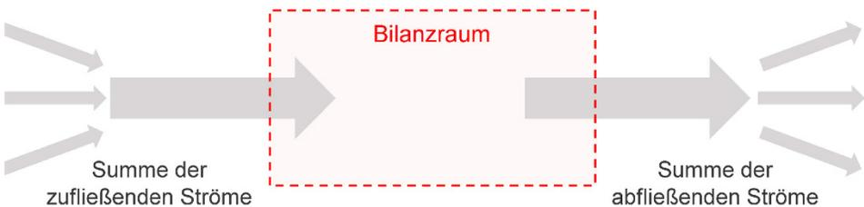
**Abbildung 5.2.8: Prinzip der prozesstechnischen Bilanzierung**
