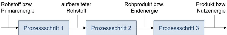
Abbildung 5.1.7: Prinzip einer Bereitstellungskette für Produkte oder Nutzenergie
