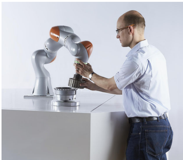
Abb. 3 Handführen des LBR iiwa, um eine Montage-Aufgabe einzulernen. Quelle: KUKA
