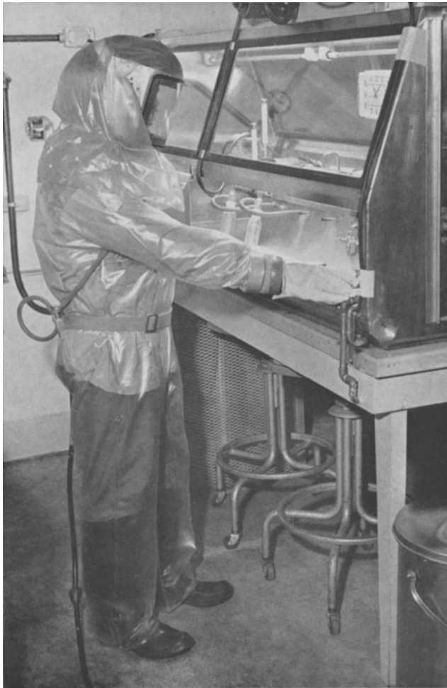
Abb. 18. Laboratoriumshelfer in Überdruck-Plastikschutzanzug vor einer Kabine, die zur Inhalationsinfektion größerer Versuchstiere (Affen) gebaut wurde (Official photograph, U.S. Navy, Naval Biological Laboratory, J. SCHUTZ, photographer)
