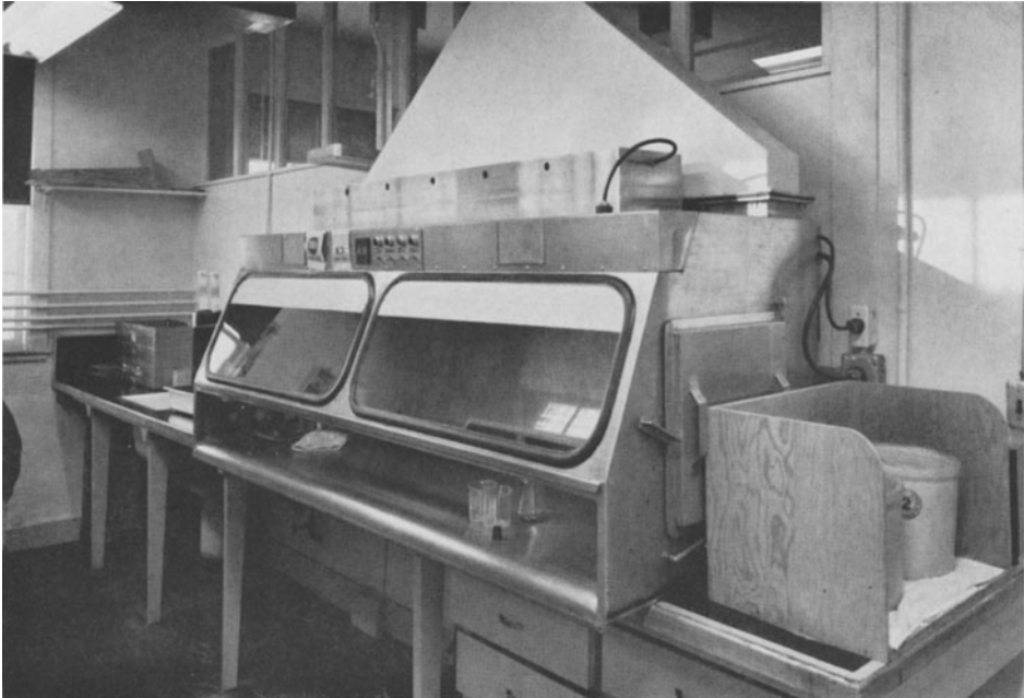
Abb. 2. Impfkabine mit offener Vorderseite, geeignet für Arbeiten mit Material (z. B. Bouillonkulturen von Hefe- und Schimmelpilzen), von dem keine Gefahr einer aerogenen Infektion ausgeht (Official photograph, U.S. Navy, Naval Biological Laboratory, J. SCHUTZ, photographer)
