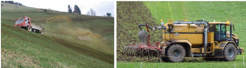
Abbildung 5.3 Herkömmliche Gülleausbringung im Vergleich zur Einbringung mit einem Güllegrubber. (Fotos: Thomas Möllers CC BY-SA 4.0)
