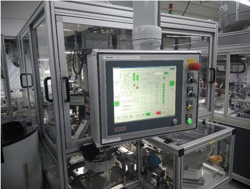
**Abb. 1** Montageanlage mit MES-Oberfläche. (Foto: Maximilian Locher)
