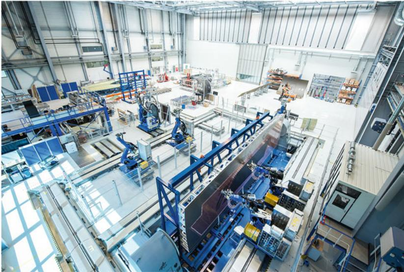
**Abb. 2.9** Anlage zur multi-robotischen Endlosfaserablage am DLR Stade
