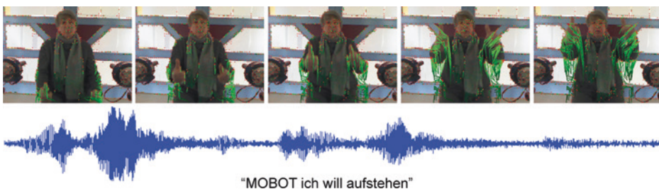
Abb. 5.7 Darstellung des kombinierten audio-gesturalen Modus. Der Teilnehmer führt die Geste (obere Reihe) und gleichzeitig einen Sprachbefehl aus (Akustikwellen untere Reihe). Die Farbelemente in der oberen Reihe sind überlagert mit Verarbeitungssignalen (Fokus: Bewegungserkennung)
