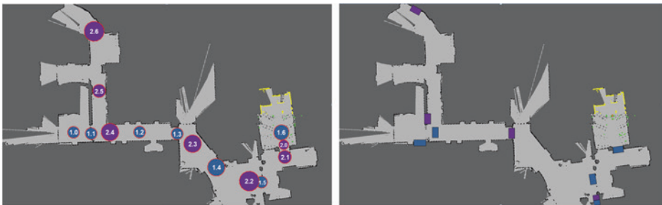
Abb. 5.3 Position der externen Sensoren (guard points) zur technischen Navigationshilfe (assistierte Navigation, linkes Bild); Kreise mit einer 1 am Anfang repräsentieren audio cues auf dem Weg zur Kapelle (1. Testabschnitt), Kreise mit einer 2 am Anfang audio cues zum Aufnahmezentrum (2. Testabschnitt). Die Größe der Kreise markieren die kritischen Zonen für die jeweiligen audio cues. Hinweisschilder zur Orientierung ohne Assistenz (rechtes Bild); blaue Vierecke markieren Hinweisschilder zur Kapelle, lila Vierecke die zum Aufnahmezentrum
