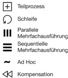
Abb. 3.38 Modifikatoren zur Abbildung unterschiedlichen Ausführungsverhaltens
