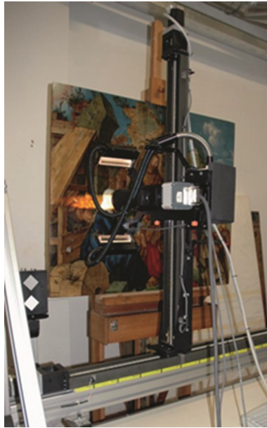
Fig. 1. IFAC-CNR HSI scanner during the measurement of the panel Adoration of the Magi (1504) by Albrecht Dürer at the former Restoration Laboratory of the Soprintendenza Speciale per il Patrimonio Storico, Artistico ed Etnoantropologico e per il Polo Museale della città di Firenze
