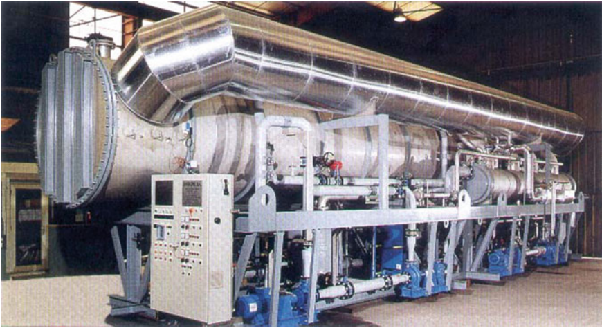
Fig. 8.3 A 768 m 3 /d offshore MED-TVC c.2000s (© Tom Pankratz)
