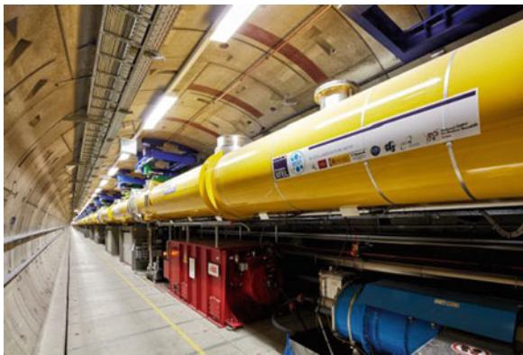
Fig. 7.4 The E-XFEL linac (©European XFEL/Heiner Müller-Elsner)
