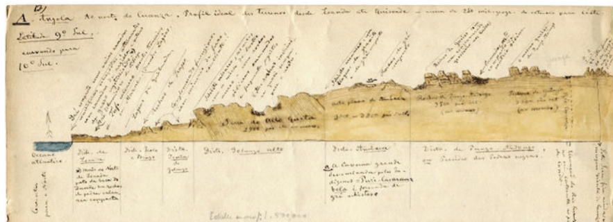
Profil idéal des terrains, de Loanda à Quisonde, commençant au 9° degré de latitude sud et s'infléchissant jusqu'au 10°.
