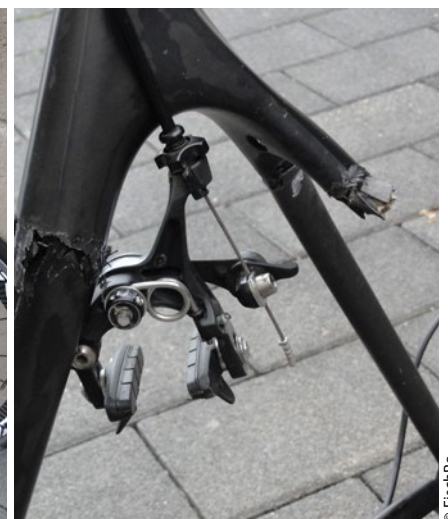
Abb. 2: Bei dem seitlichen Aufprallunfall mit einem PKW wurde das Rennrad schwerer lädiert als sein Fahrer.
