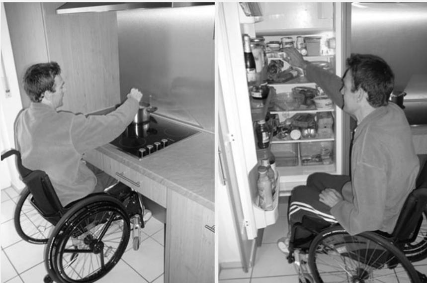
**Abb. 10** ◀ Küchenumgestaltung, **a** unterfahrbare Arbeitsplatte, **b** Schränke in Greifhöhe
