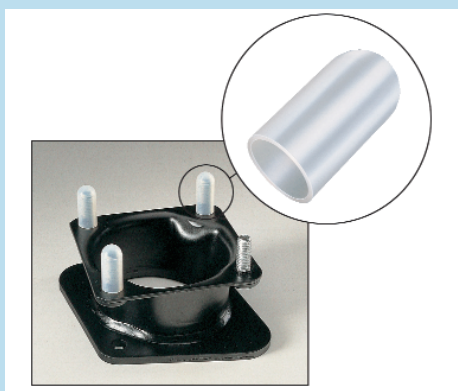
Bild 4: Die Schutzkappen schützen beim Pulverbeschichten das Gewinde der Befestigungsschrauben am Flansch, und sie lassen sich problemlos und ohne festzubacken wieder abziehen
