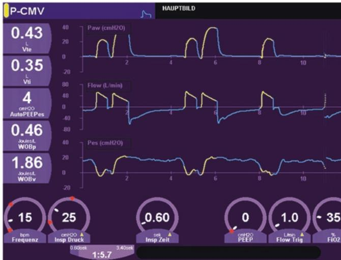
■ **Abb. 8.5** Die Flusskurve (Flow) und Druckkurve (Paw) zeigen einen zweigipfligen Verlauf (sog. Doppeltriggern) bei zu kurz eingestellter Inspirationszeit (hier 0,6 Sekunden). Im Ösophagussignal (Pes) ist erkennbar, dass innerhalb einer Atemanstrengung des Patienten 2 Atemzüge im Gerät ausgelöst werden
