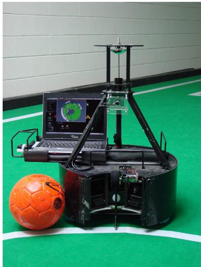
**Fig. 1.** A CAMBADA robot
