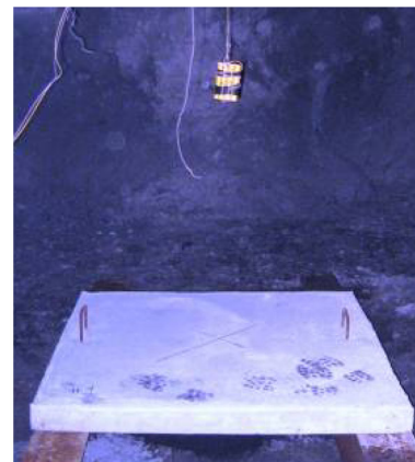
Fig. 3 Blast test setup
