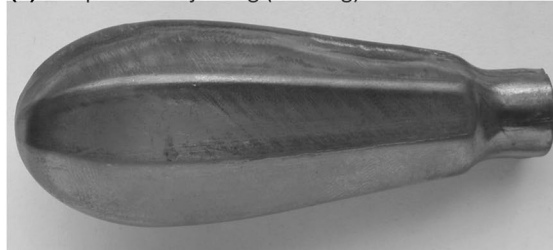
(d) 4 th operation - joining (welding)
