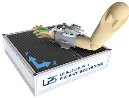
Abb. 1 Prototyp eines Greifrehabilitationsroboters für die synchrone Therapie der Transport- und Greifphase Fig. 1 Prototype of a grasping rehabilitation robot for synchronous therapy of transport and grasping phase
