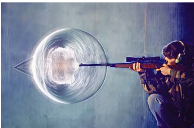
Abb. 6 Schlierenaufnahme – Ausbreitung der Stoßwelle beim Gewehrschuss (Settles 2004)
