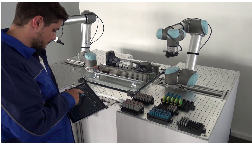
Abb. 3 Konzeptdemonstrator des soziotechnischen Assistenzsystems. Er besteht aus (1) einem kollaborativen Roboter, (2) einer ontologiebasierten Zuweisungsautomatisierung und (3) einer grafischen Mensch-Maschine-Schnittstelle, die es erlaubt, Zuweisungen individuell anzupassen
