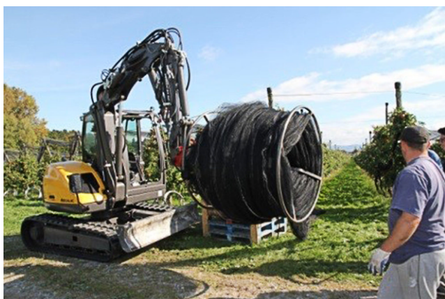
Abb. 5 Aufrollen gebrauchter Hagelnetze (HD-PE) zum Recyclen. (© R. Holzwarth, BayWa)
