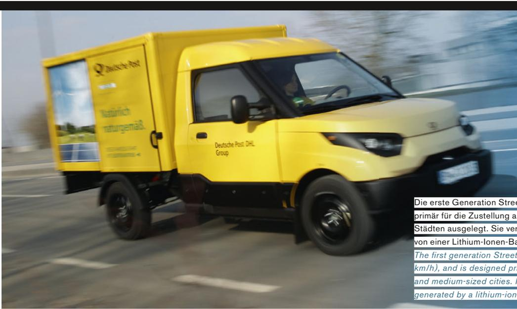
Die erste Generation StreetScooter fährt bis zu 80 km/h schnell und ist primär für die Zustellung auf dem Land sowie in kleineren und mittleren Städten ausgelegt. Sie verfügt über eine Leistung von bis zu 30 kW, die von einer Lithium-Ionen-Batterie und einem Asynchronmotor erzeugt wird.
