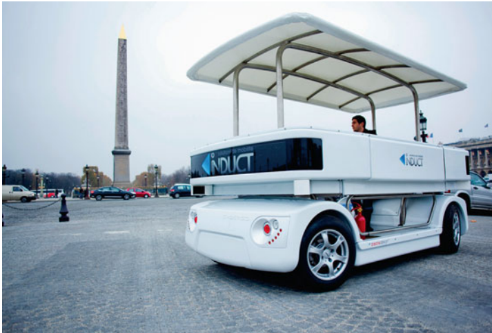
Abb. 14.2 Offene Bauweise des Induct Navia [2] (Abbildung mit freundlicher Genehmigung der Fa. Induct)
