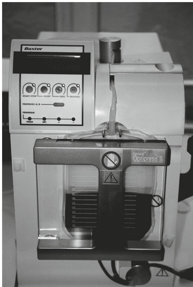
■ Abb. 16.2 Optipress II der Fa. Baxter als Beispiel für einen automatischen Blutkomponenten-Extraktor. Bei diesem System wird das Vollblut nach der Zentrifugation in einem Beutel mit 2 abführenden Schläuchen zwischen 2 parallelen Platten zusammengepresst. Gesteuert durch optische Sensoren und wechselnd schließende Klemmen am oberen und unteren Schlauch kann aus dem Vollblut plättchenarmes Plasma (nach oben) und Buffy-coat-armes Erythrozytenkonzentrat (nach unten) abgepresst werden. Dabei dient ein voreingestelltes und vom Automaten überwachtes Buffy-coat-Volumen als Stoppkriterium. Auch die Weiterverarbeitung gepoolter »buffy coats« kann nach der Zentrifugation im Blutkomponenten-Extraktor erfolgen: Der Überstand wird als Thrombozytenkonzentrat abgepresst. Die Detektion von Hämoglobin im abführenden Schlauch beendet den Abpressvorgang. Ein Buffy-coat-Rückstand verbleibt im Beutel zwischen den Platten. Die Automatisierung der Komponententrennung bietet neben dem Vorteil höherer Effizienz (Bedienung mehrerer Automaten durch eine Person) den Vorteil einer besser standardisierten Aufarbeitung des Spenderblutes. Ein weiterer verfügbarer Automat ist der Compomat G4 der Fa. Fresenius
